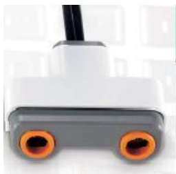
Ultrasonický senzor: Meria vzdelenosti k objektom a reaguje na pohyb
