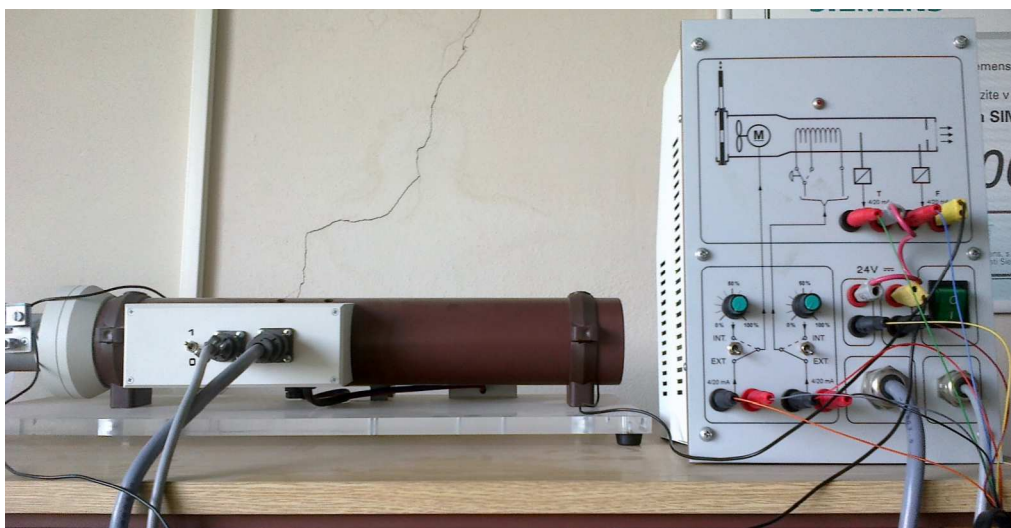
Obr. 1. Laboratórny výmenník tepla LTR 700
