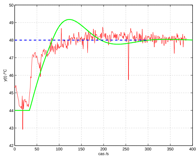
Obr. 2.9: Priebeh riadenia teploty t_4 pomocou PID regulátora.
