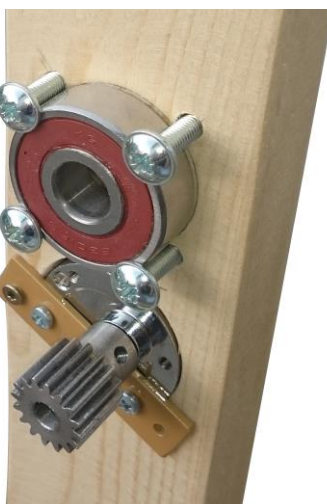
Obrázok 3.4 Ložisko 2, pevne uchytené k pravej časti držiaku na rám skrutkami M5
