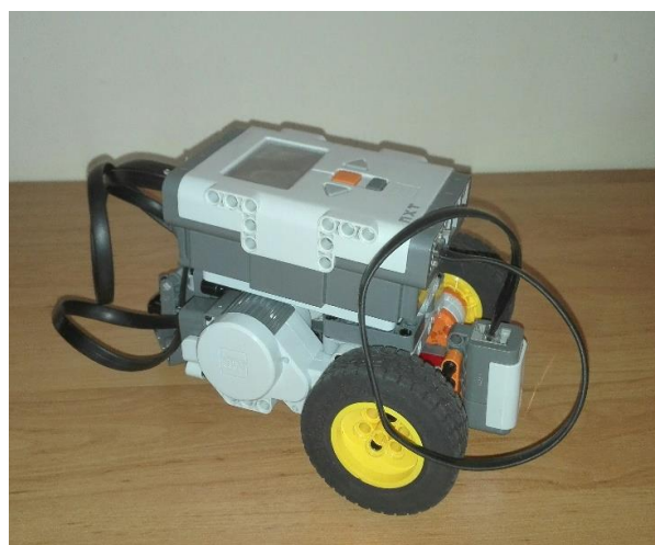
Obr. 5.22. a Obr. 5.23: NXT robot s jedným svetelným senzorom
