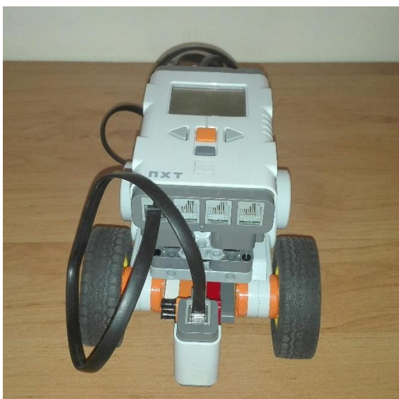
Obr. 5.22. a Obr. 5.23: NXT robot s jedným svetelným senzorom
