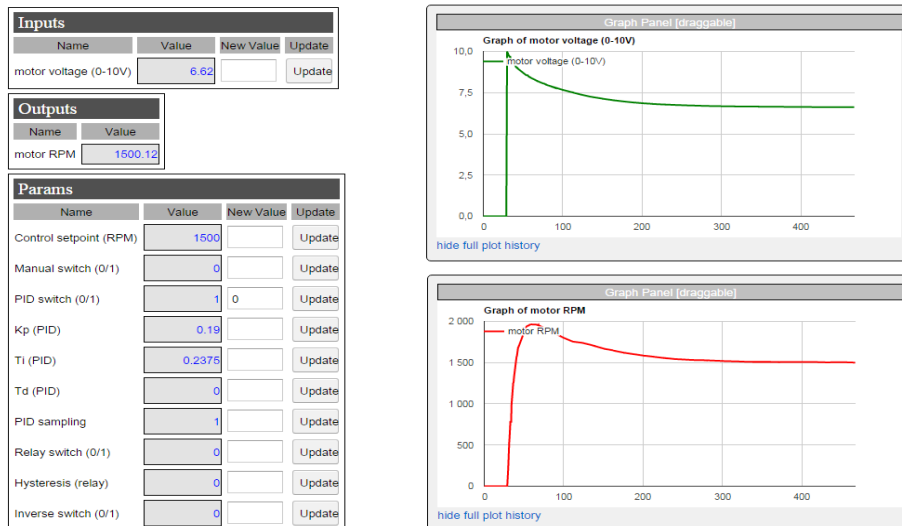
Obr. 19 Overenie návrhu parametrov PI regulátora pre reálny laboratórny proces
