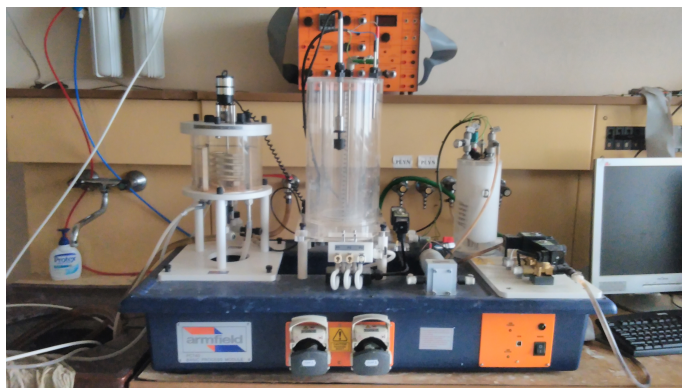
Obr. 2.1: Laboratórny chemický reaktor Armfield PCT40.
