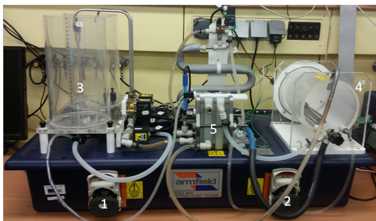
Obr. 2.1: Výmenník tepla Armfield Process Plant Trainer PCT23: čerpadlo na studené médium F (1), čerpadlo na horúce médium W (2), zásobníky studeného média (3), ohrevný kotol pre horúce médium (4), doskový výmenník tepla (5).
