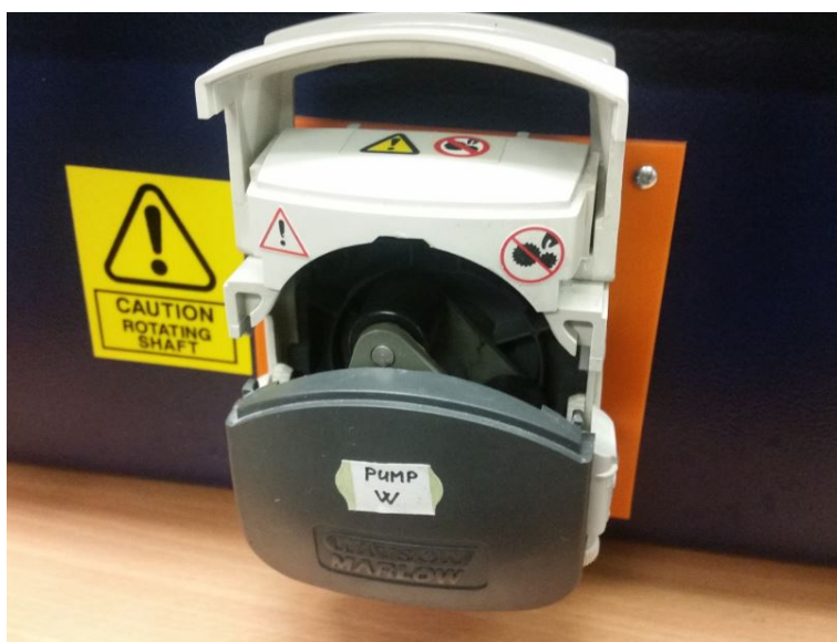
Obr. 2.2: Čerpadlo privádzajúce horúce médium W.
