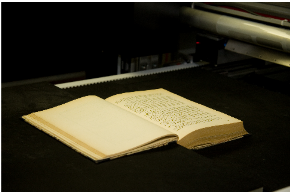
Obr.5 Platne sa prispôsobia hrúbke knihy, aby kniha bola vo vodorovnej polohe.
