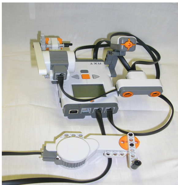
Obr. 25 Obrázok lego robota zostaveného na riadenie brány s pomocou fotobunky
