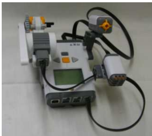
Obr. 32 Obrázok lego robota zostaveného pre úlohu merania reakcií
