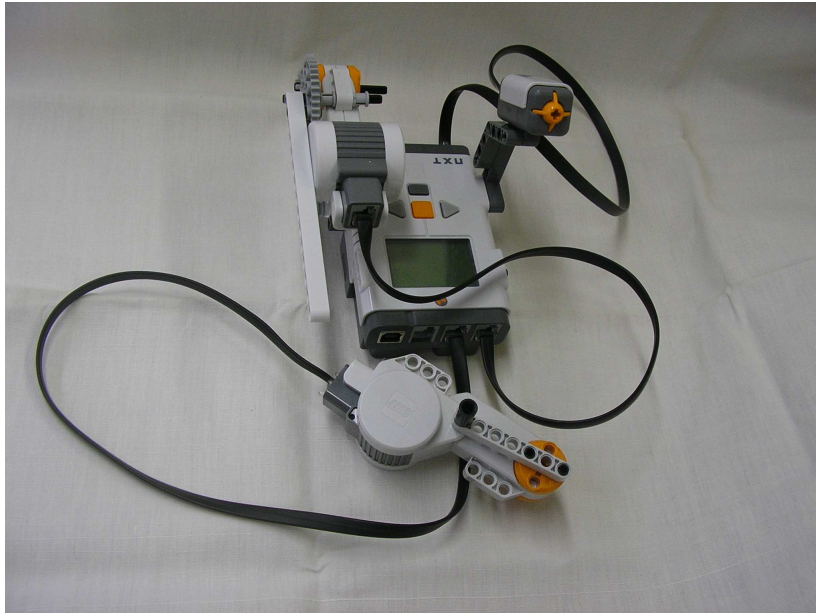
Obr. 23 Obrázok lego robota zostaveného pre otváranie a zatváranie brány
