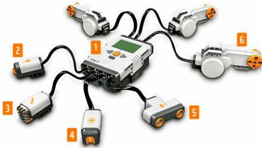
Obr. 15 Riadiaca kocka NXT so zapojenými akčnými členmi a senzormi
