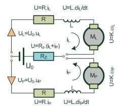
Fig. 6 Motors wiring
